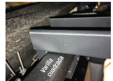
Soporte "enganchado" en la varilla cuadrada
