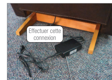
Cordon d'alimentation 120 volts Transformateur électrique
